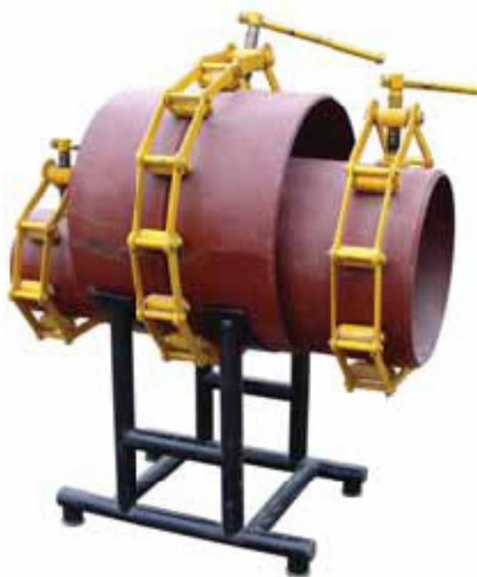
Центраторы звенные наружные ЦЗН предназначены для центровки торцов труб диаметром от 57 мм до 1420 мм в полевых условиях перед сваркой стыков при температуре окружающего воздуха от – 40 до + 40 градусов С. Механизм стягивания центратора — винтовой. Модельный ряд звенных центраторов: ЦЗН 57, ЦЗН 76, ЦЗН 89 111, ЦЗН 151, ЦЗН 211, ЦЗН 271, ЦЗН 321, ЦЗН 421, ЦЗН 530, ЦЗН 630, ЦЗН 720, ЦЗН 820, ЦЗН 1020, ЦЗН 1067, ЦЗН 1220, ЦЗН 1420.
